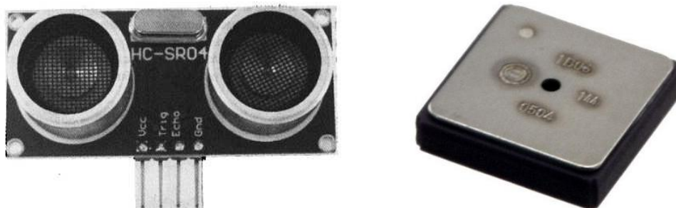
Fig. 2. a.Ultrasonic Sonar HC-SR04.
